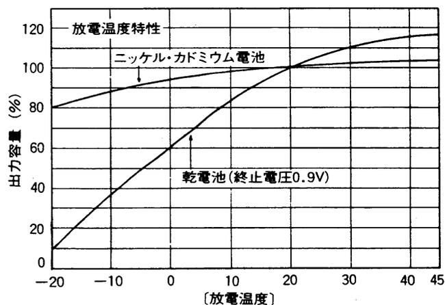
乾電池は、気温が低下するほど容量の減少が著しくなります。通常、乾電池の使用可能な温度の下限は、 $-10^{\circ}\text{C}$ とされていますから、寒冷地でご使用になる場合は電池部分を暖かく(充分保温する)してご使用になるか、ニッカド電池のご使用をおすすめします。
