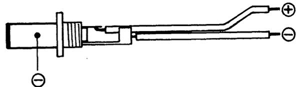
付属のバッテリーパック以外に $12\sim 13.8V$ の範囲で安定化された外部電源を接続する端子です。接続には、付属のDC電源プラグをご使用ください。
