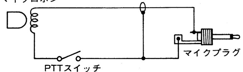
インピーダンスは $200\Omega$ ~ $1K\Omega$ で、感度は $1\mu\text{bar}$ -65~-70dBのものが使用できます。
