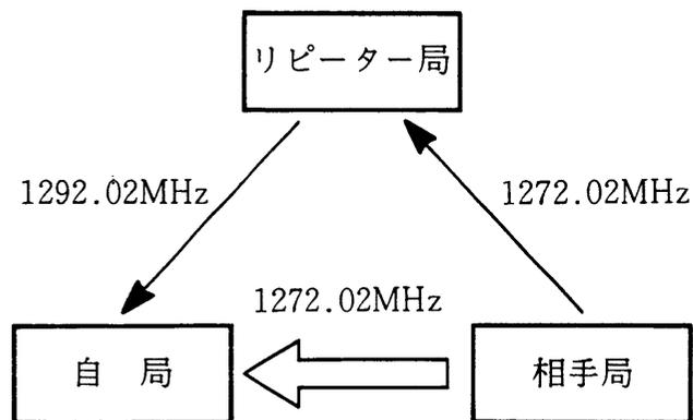
FUNCを押しながらREVERSEを押すと、1272.02MHzで受信状態になり、デュプレックス交信が可能範囲なら直接相手局の電波が届く
