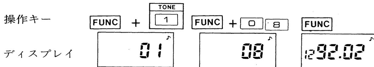
※トーンエンコーダーをOFFにする場合は、再度FUNCスイッチを押しながらトーンキーを押してください。トーン表示は消灯し、OFFになります。
